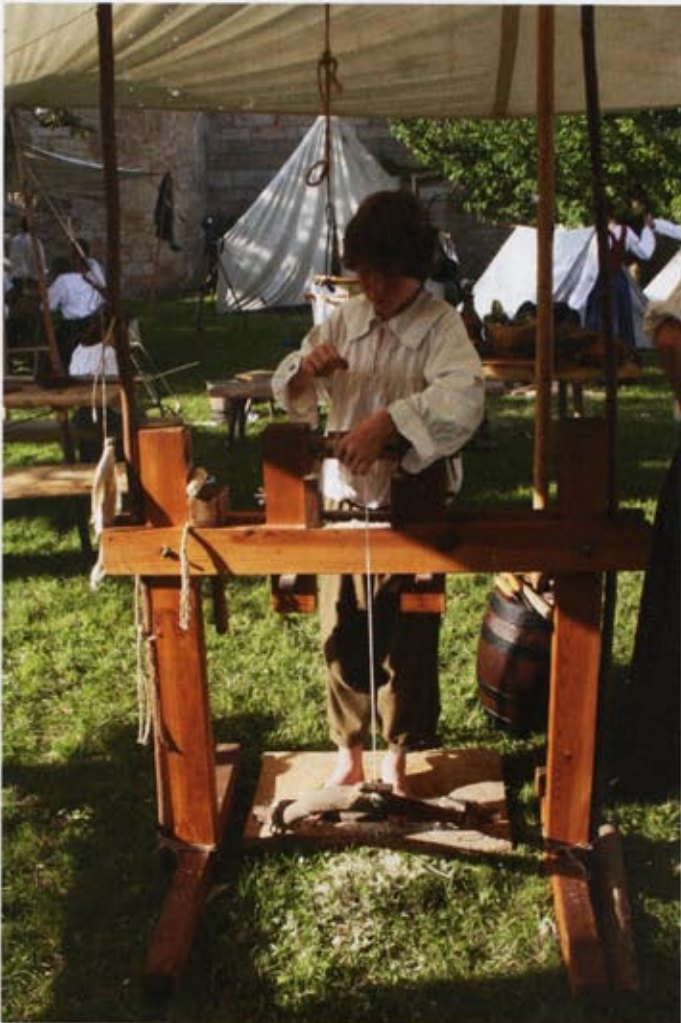
Besser als Schule: Landsknechtsdasein ist auch heute etwas für die ganze Familie. Der junge Hobbyist versucht sich im authentischen Outfit an einer fußbetriebenen Drechselmaschine.
